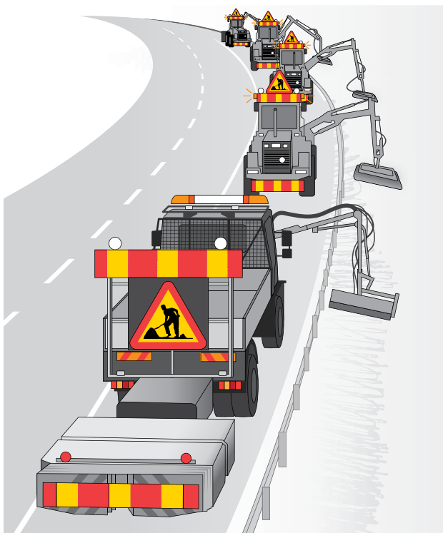
Exempel på ett så kallat slåttertåg som här består av fem fordon, en bild från verkligheten.
