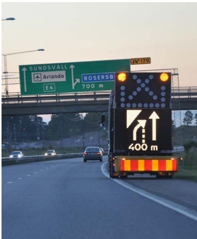
Varningsfordon med TMA och förvarning med lysande VMS.
